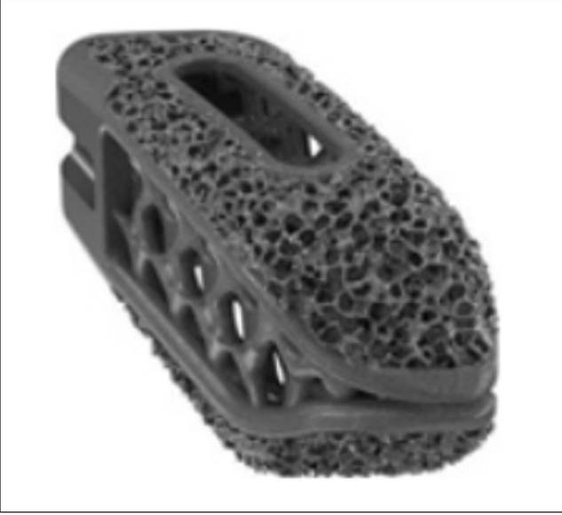
Şekil 1: Mekanik direnci artırmak, sabitleme ve çekme kuvvetine karşı direnci yükseltmek ve elastik modülü azaltmak için yüzey pürüzlenmesi artırılmış titanyum PLIF kafes.
