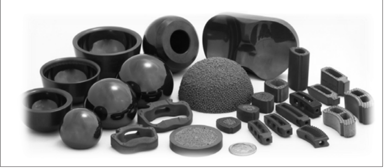
Şekil 4: Fraktüre karşı dirençli bir yapısından dolayı özellikle kalça protezlerinde tercih edilen radyolüsen seramik materyal olan silikon nitrit, omurga cerrahisinde de özellikle lomber kafesler olmak üzere yerini almaya başlamıştır.
