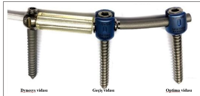
Şekil 2: Dynesys-Transition-Optima (DTO) (Zimmer Spine) implantının fotoğrafı: Bir polyester ara parça (dış çap = 11,0 mm ve kalınlık = 2,0 mm) ve dinamik olarak stabilize edilmiş segmentteki kablo (dinamik bileşen), sert sabit segmentte (statik bileşen) bir titanyum rod (çap = 6 mm), ve statik ve dinamik bileşenleri bağlayan bir geçiş vidası. DTO ara parçasının ve statik bileşenlerin uzunluğu, pediküllerin doğal mesafesine göre belirlenir (Kaynak 18'den).
